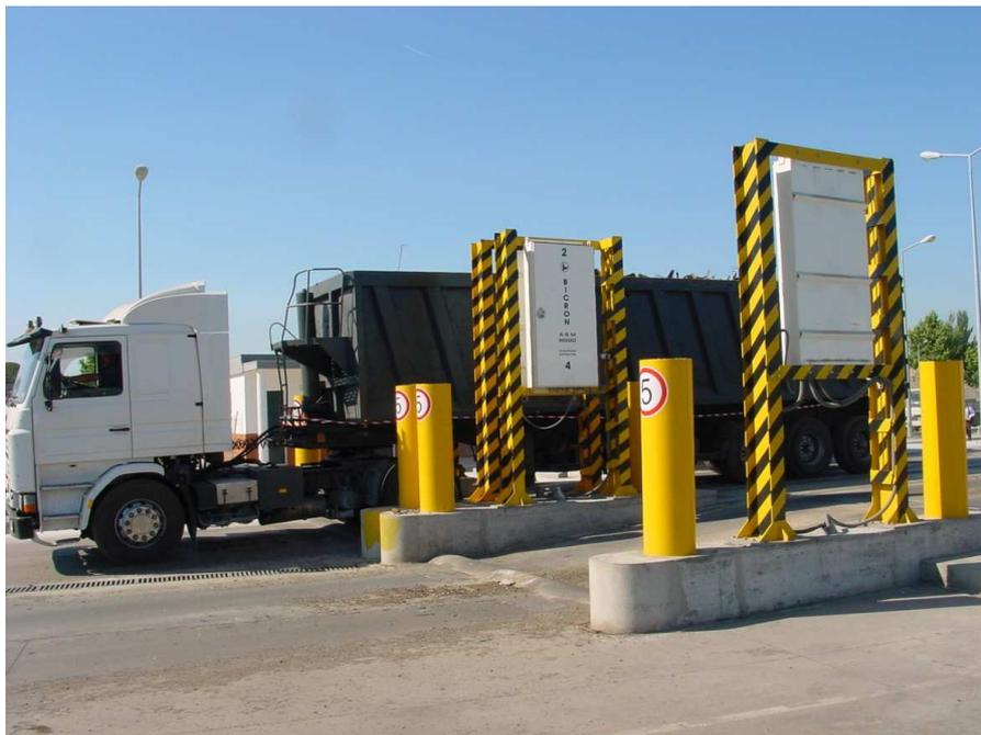
Figura 2 - Pórticos para detecção de substâncias radioactivas em camiões.
